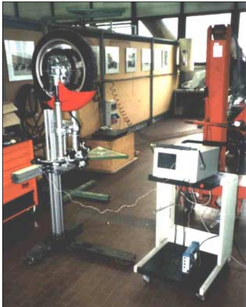
Foto 2.11. Esempio di misurazione dell'inerzia dell'avantreno tramite "il banco di misura inerziale". Si nota anche l'analizzatore FFT Ono Sokki in primo piano, con relativo amplificatore.
