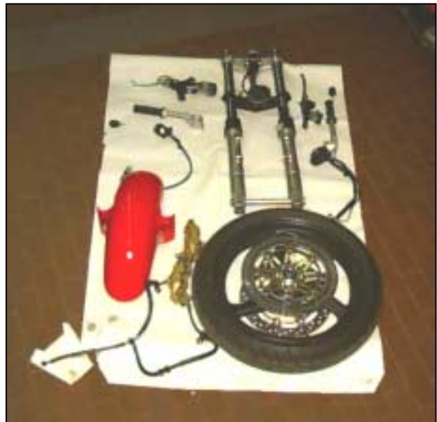
Foto. 2.9. Avantreno smontato nei singoli componenti
