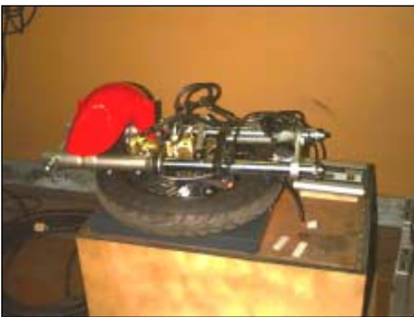
Foto. 2.10. Pesata dell'avantreno smontato
