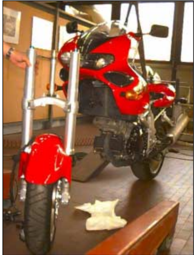
Foto. 2.8. L'avantreno completo viene smontato dalla motocicletta
