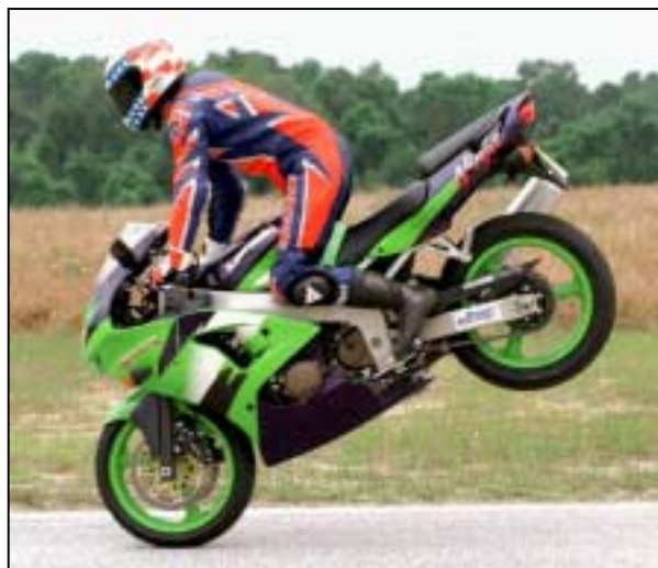
Foto I.2. Trasferimento del carico in frenata
